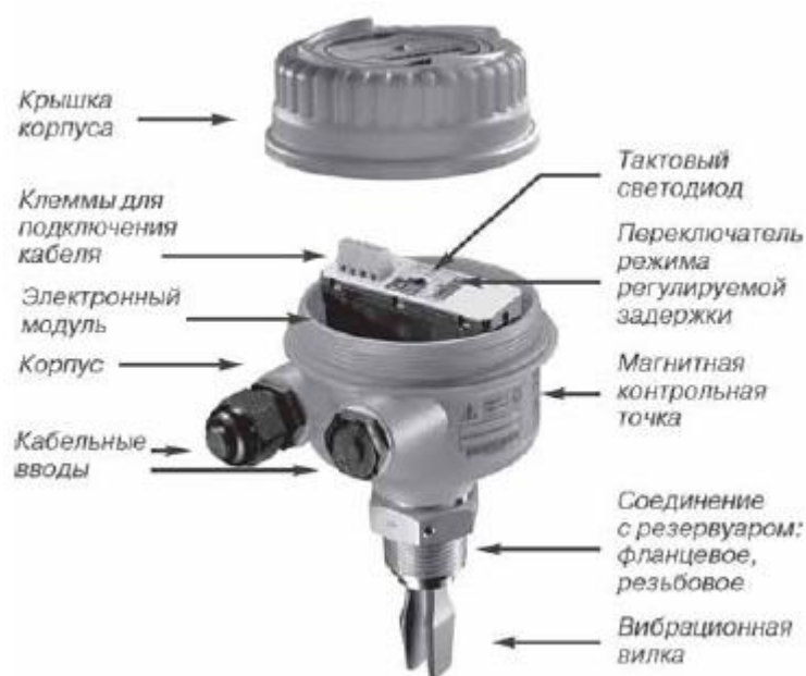
Рисунок 23 – Конструкция сигнализатора уровня
