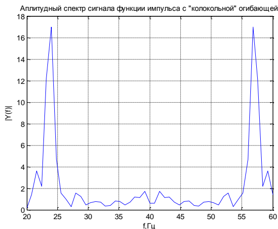
Рисунок 9 – Амплитудный спектр функции импульса с «колокольной» огибающей с добавлением шума
