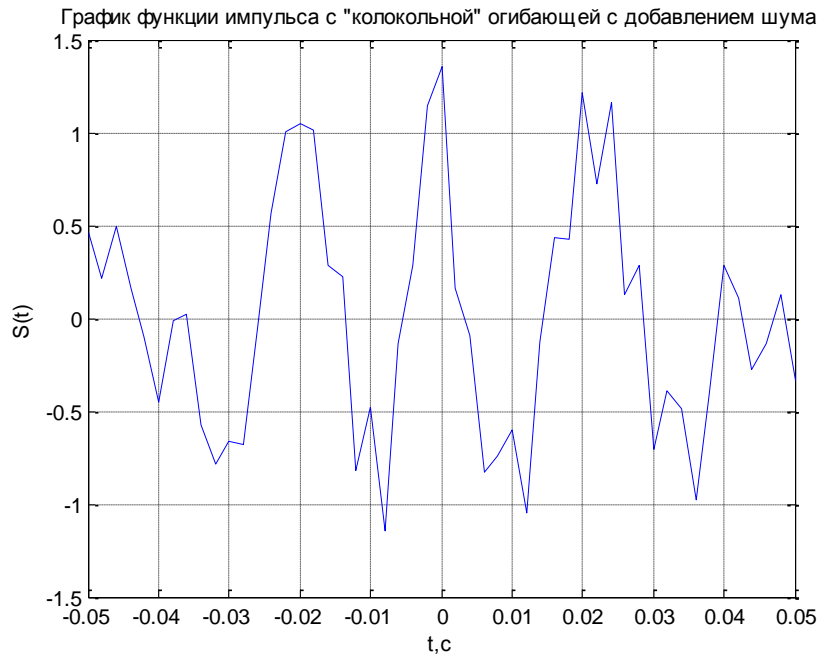
Рисунок 6 – График функции исходного сигнала с добавлением шума
