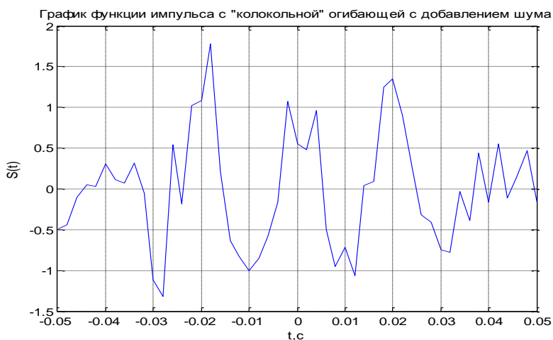
Рисунок 17 – Входная функция, заданного в виде суммы импульсов с «колокольной» огибающей в точках [- 0.02; 0; 0.02] и с добавлением гауссовского шума.
