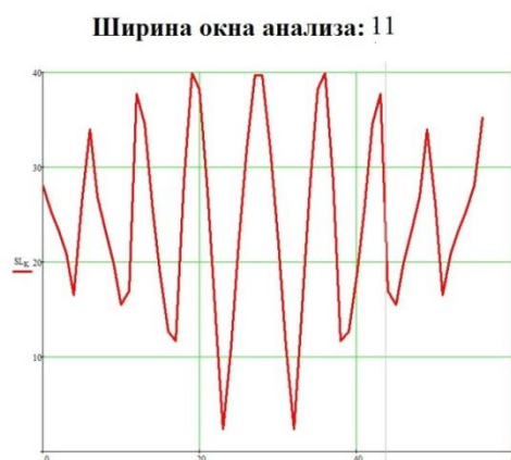
Рисунок 23 – График функции правдоподобия при сдвиге между импульсами 60 мс
