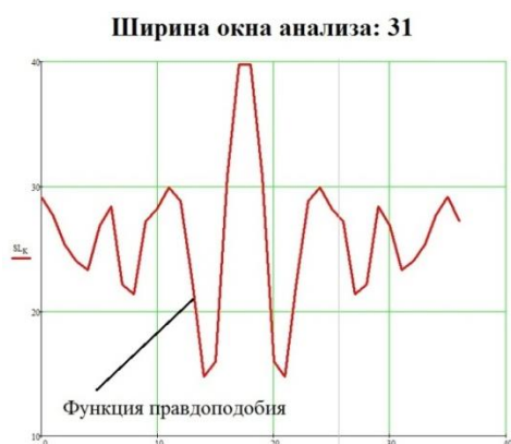
Рисунок 22 – График функции правдоподобия при сдвиге между импульсами 10 мс
