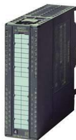
Рисунок 3.2.6.4.1 – Модули ввода-вывода ПЛК и ET200M
