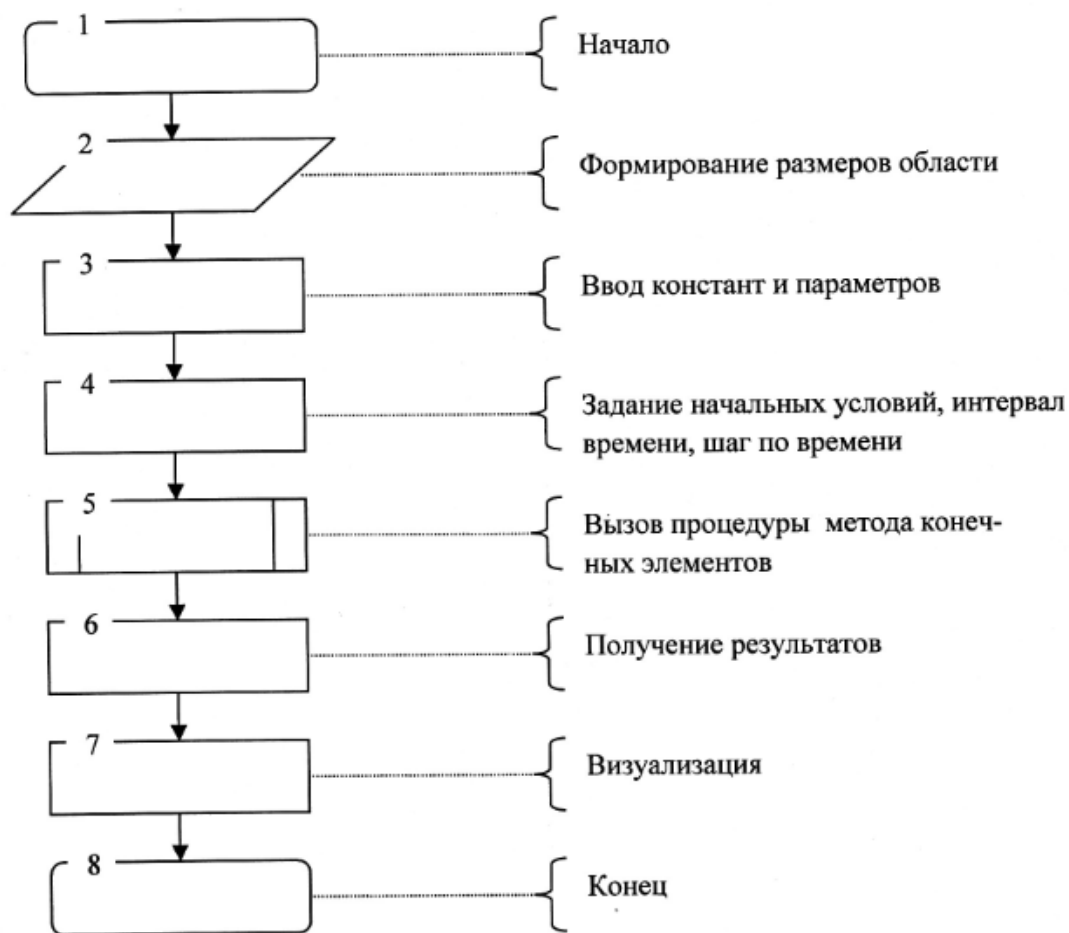
Рис. 6. Блок-схема алгоритма моделирования электрических сигналов в сердце
