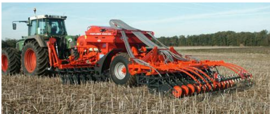
Рисунок 3.5 - Прицепные пневматические сеялки нулевого цикла почвоподготовки FASTLINER.
