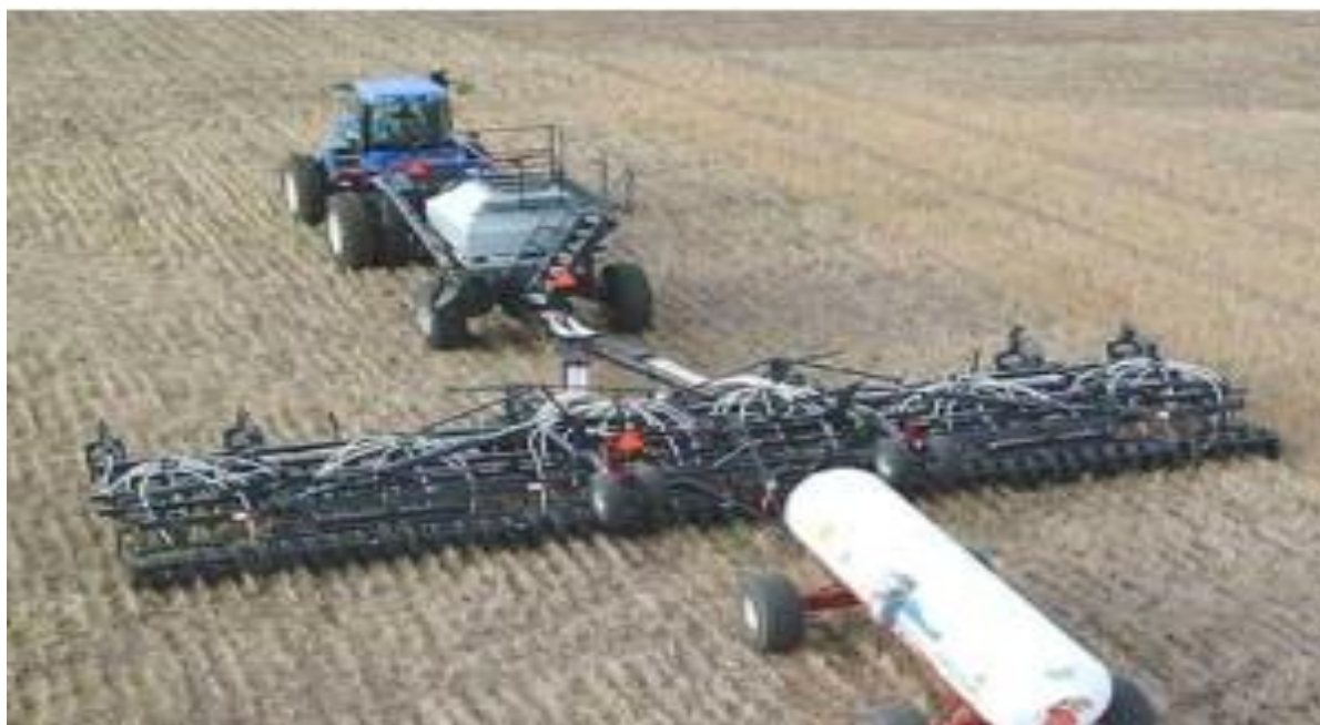
Рисунок 3.3 - Сеялка зерновая пневматическая сеялка нулевого посева FLEXI-COIL 5000
