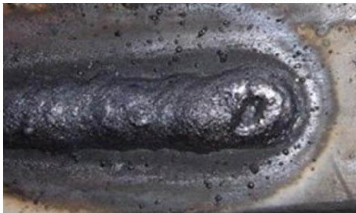
Рисунок 7 – Дефект сварного шва типа – кратер
