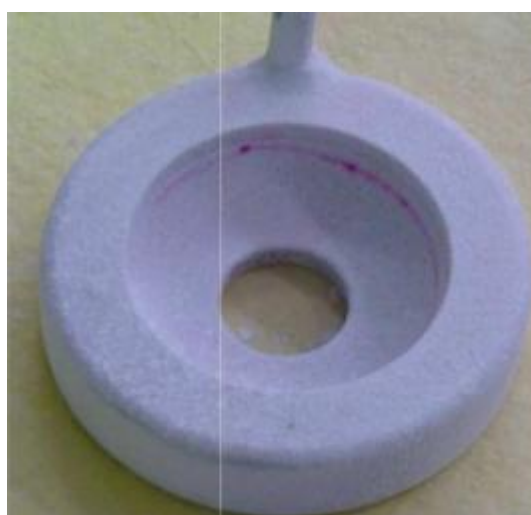
Рисунок 16 – Микротрещина в образце полученная путем тепловой обработки
