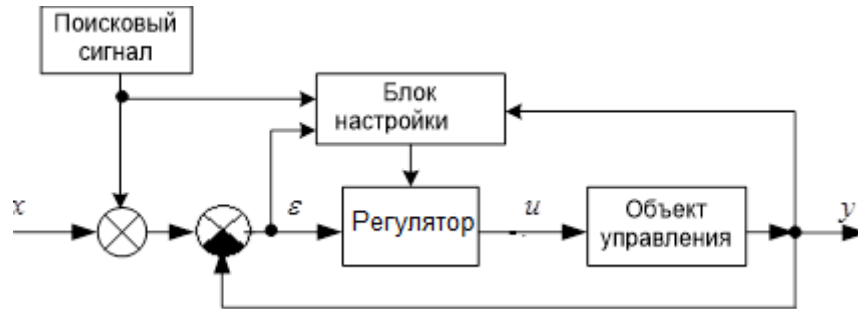
Рисунок 5.13 – Структура адаптивной системы с поисковым сигналом
