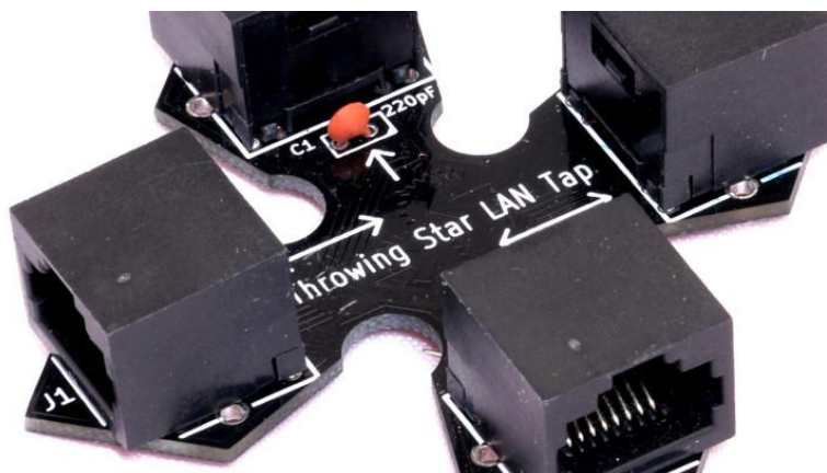
Рисунок 2 – Внешний вид устройства для подключения в разрыв линии связи
