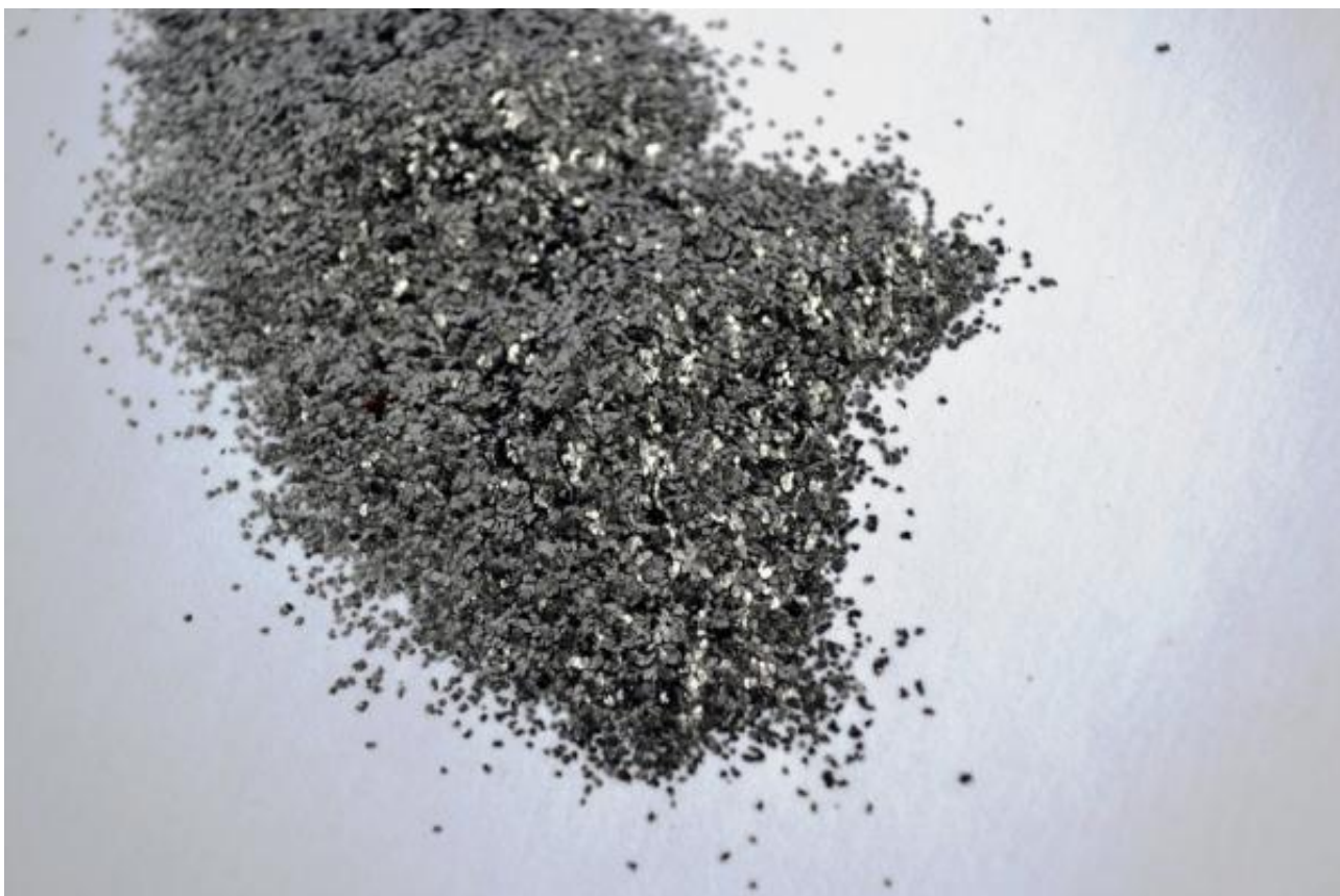
Рисунок 3 – Криптол (пористый наполнитель для горелки)
