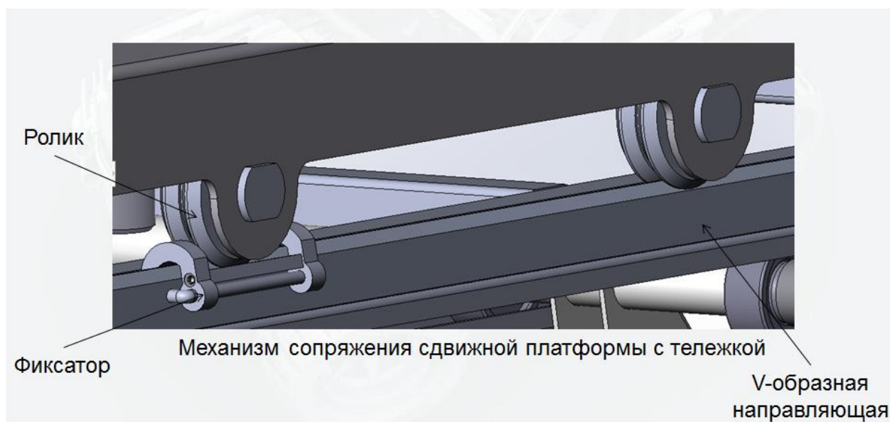
Рис.11. Механизм сопряжения сдвижной платформы с тележкой
