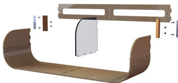
Рисунок 13 – Полка, вид с разнесенными частями
