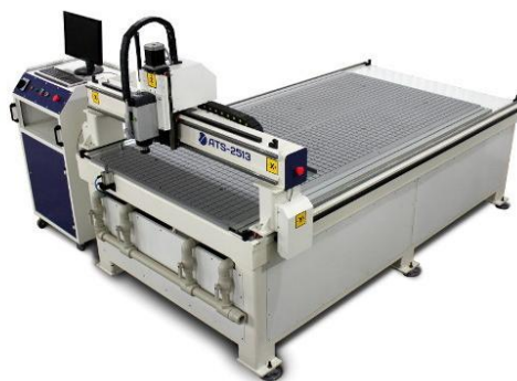
Рисунок 17 – Фрезерный станок портального типа ATS-2513
