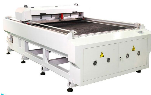
Рисунок 16 – Лазерный станок HS-B1325M для резки металла и неметалла
