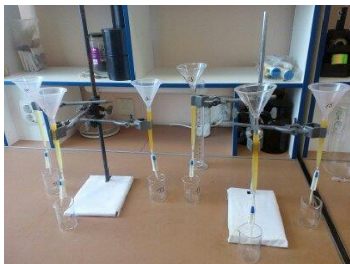
Рисунок 22 – Десорбция плутония на ионообменной колонке
