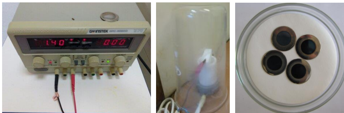
Рисунок 23 – Электроосаждение изотопов плутония на подложку
