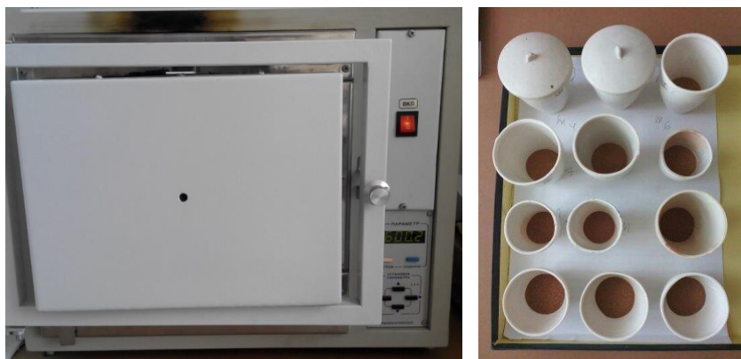
Рисунок 20 – Озолье проб в муфельной печи, прокаливание при 600°C
