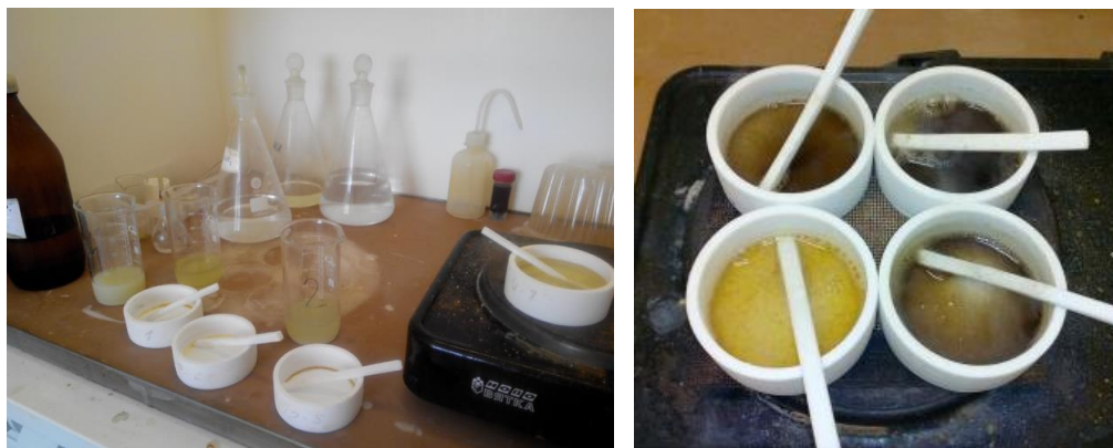
Рисунок 21 – Разложение – перевод пробы из сухой фракции в раствор
