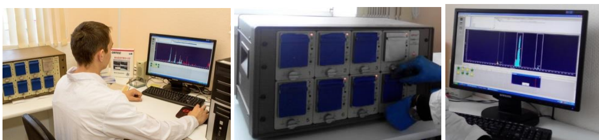
Рисунок 24 – Альфа-спектрометрический анализ в лаборатории МИНОЦ «Урановая геология» ТПУ
