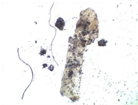
Рисунок 4.2.4 - Синтетические волокна и частица деревообработки, увеличение 35х
