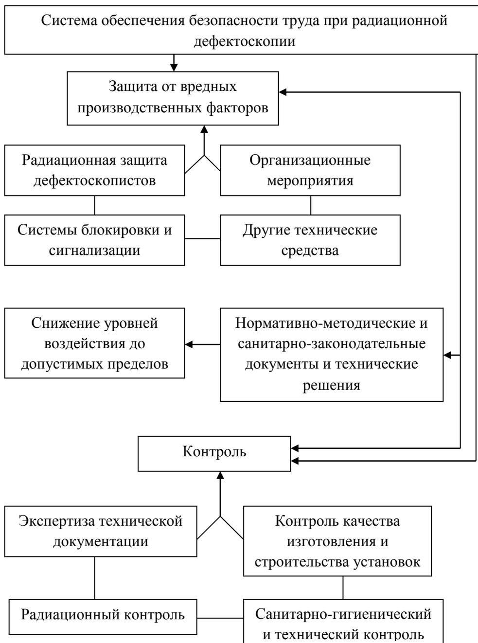
Рисунок 13 – Структура системы обеспечения безопасности условий труда при радиационном контроле
