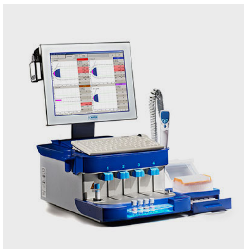
Рисунок 2 – а) четырёхканальный ТЭГ – Rotem delta; б) схематичный принцип работы ТЭГ
