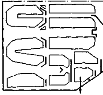
Рисунок 3.8 – Компоновка трубного пучка конденсатора 300-КЦС-1 (3) ЛМЗ
