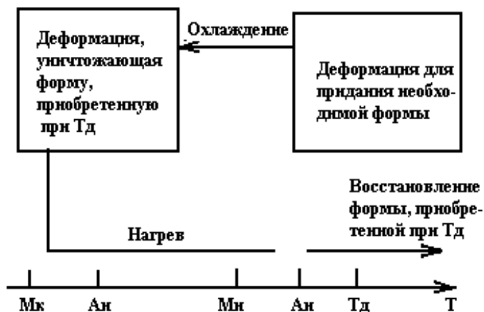
Рисунок 8. Схематическая интерпретация эффекта памяти формы: M_n , M_k – температуры начала и конца прямого мартенситного превращения; A_n , A_k – температуры начала и конца обратного мартенситного превращения; T_d – температура деформации; A_n A_k – температурный интервал восстановления формы.
