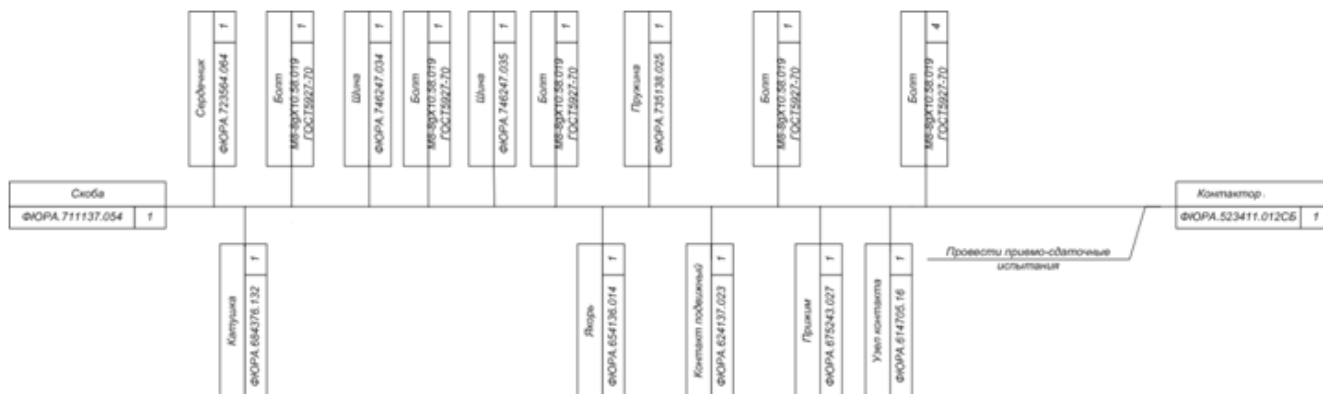
Рисунок 20 – Схема сборки контактора постоянного тока
