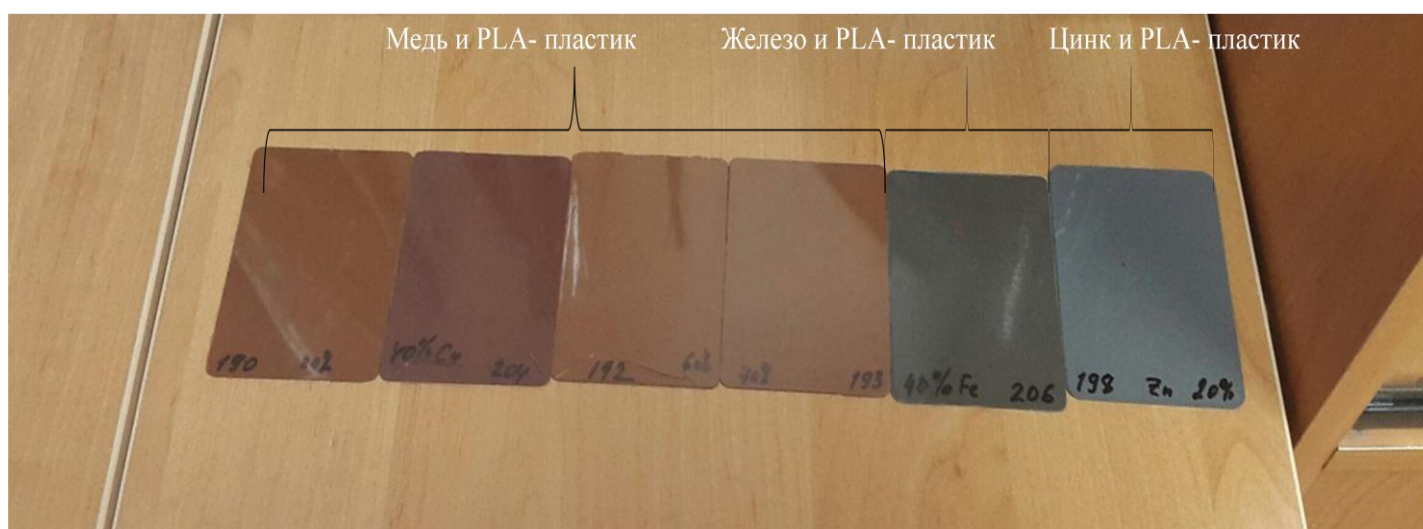
Рисунок 9. Готовые пластины с примесями меди, железа и цинка.
