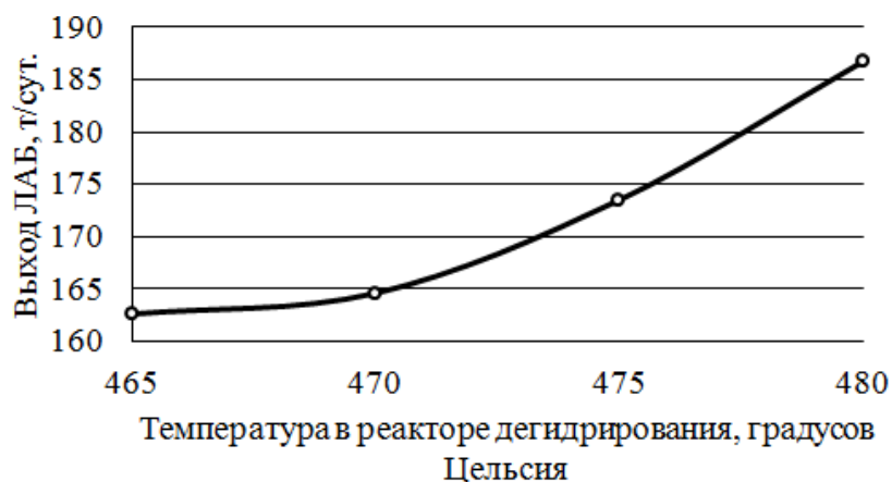
Рисунок 14 – Влияние температуры в реакторе дегидрирования на выход ЛАБ
