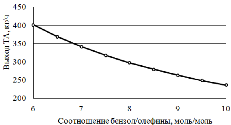
Рисунок 17 - Зависимость выхода ТА от соотношения «бензол/олефины» (соотношение олефины/диолефины = 90, температура входного потока = 55 °С, соотношение HF на регенерацию к ЛАБ = 1:1, соотношение парафины/олефины = 8:1)
