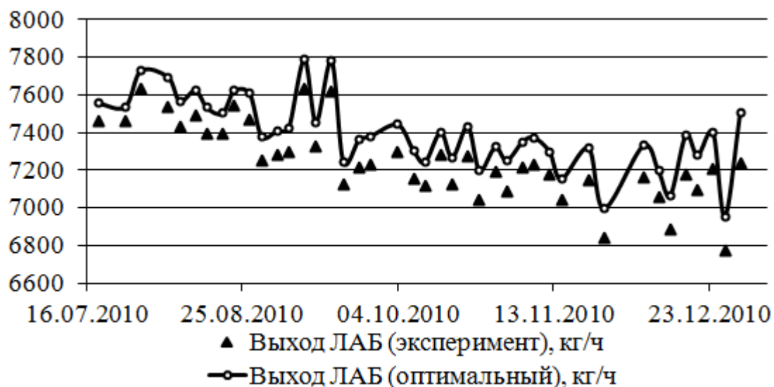
Рисунок Ж.1 – Сравнение значений выхода целевого продукта для базового и оптимального режимов работы
