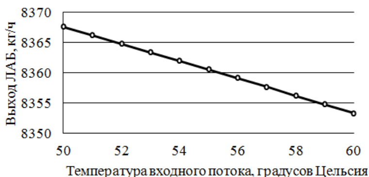
Рисунок 20 - Зависимость выхода ЛАБ от температуры входного потока (соотношение олефины/диолефины = 90, соотношение «бензол/олефины» = 8:1, соотношение HF на регенерацию к ЛАБ = 1,0, соотношение парафины/олефины = 8:1)
