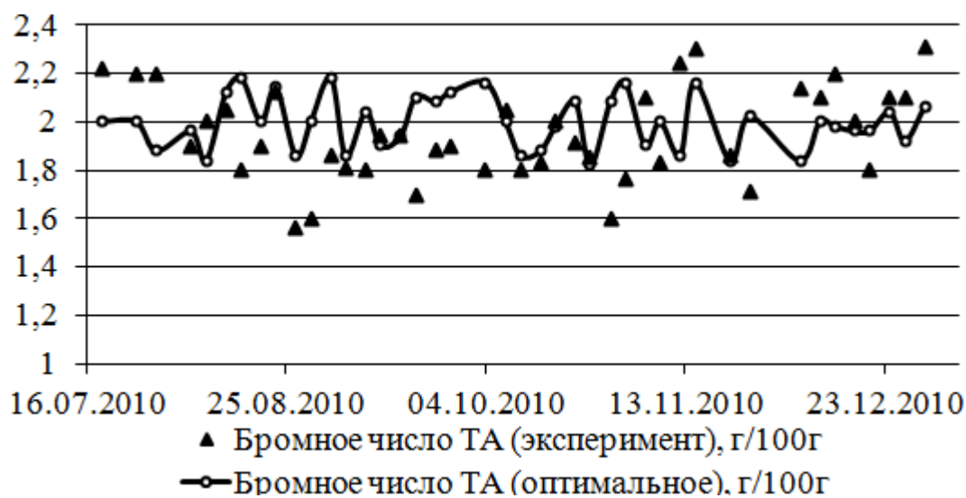
Рисунок Ж.4 – Сравнение значений бромного числа ТА для базового и оптимального режимов работы
