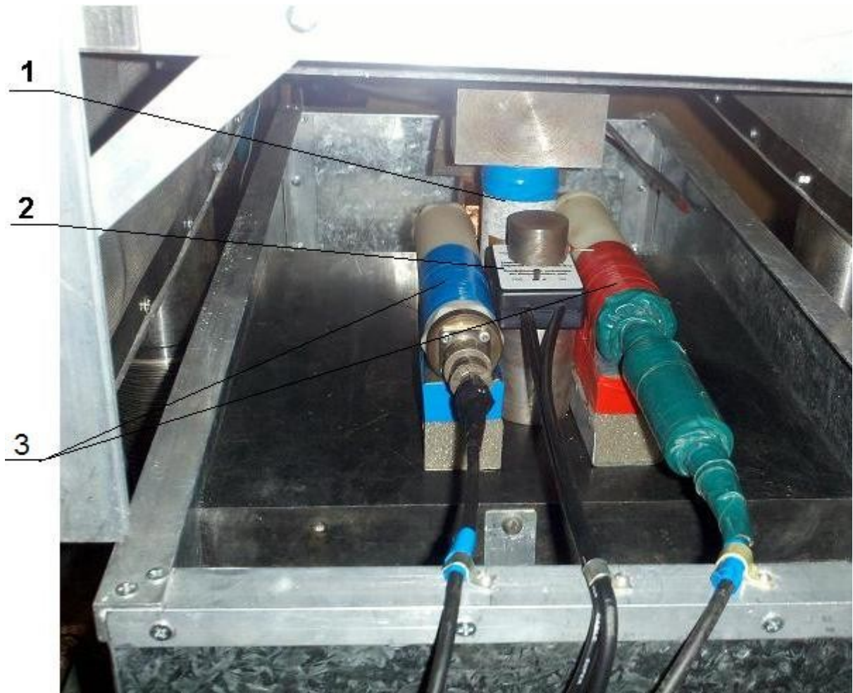
1 – образец; 2 – емкостной датчик; 3 – индукционные датчики.
