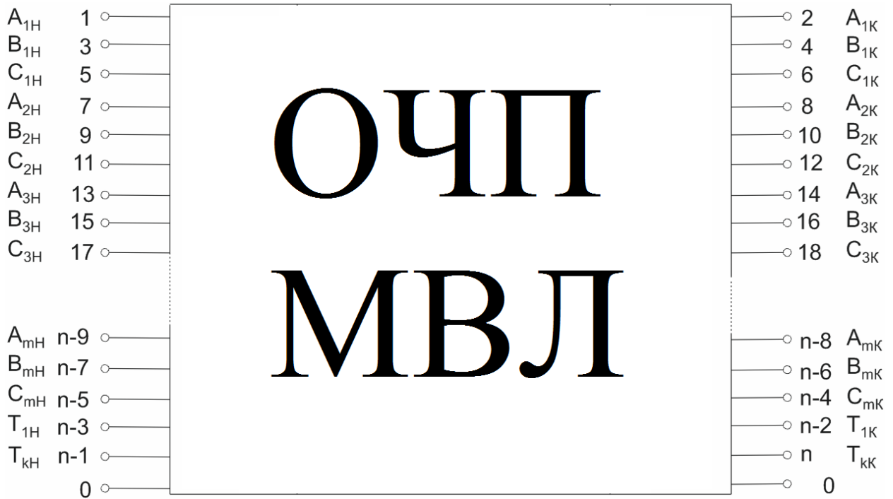
Рис. 2.9. Модель МВЛ в виде обобщённого четырёхполюсника для m -цепной ВЛ с k грозозащитными тросами.
