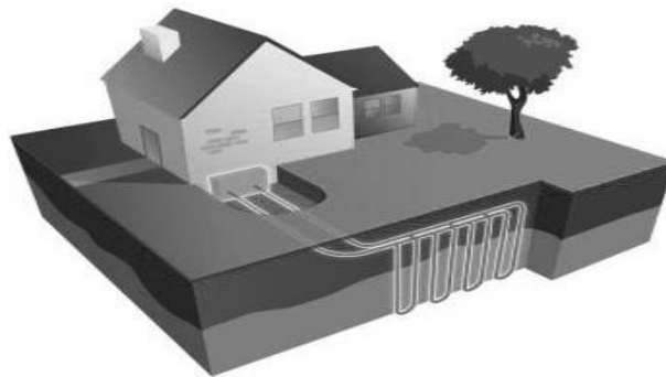
Рисунок 3. – Внешний контур теплового насоса вертикального типа
