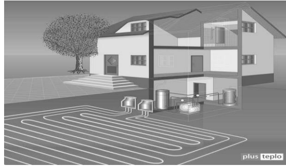
Рисунок 2. – Горизонтальный внешний контур теплового насоса жилого дома
