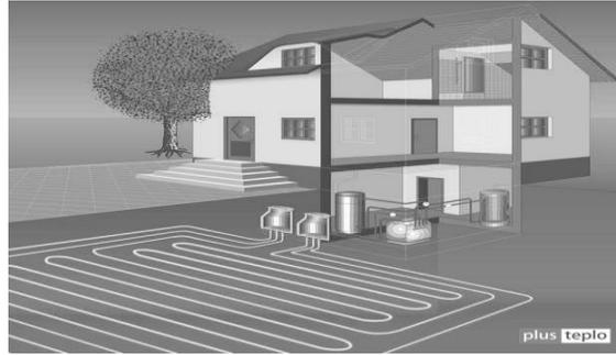
Рисунок 2. – Горизонтальный внешний контур теплового насоса жилого дома
