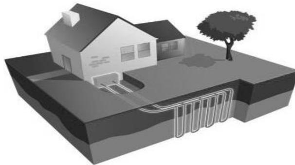
Рисунок 3. – Внешний контур теплового насоса вертикального типа
