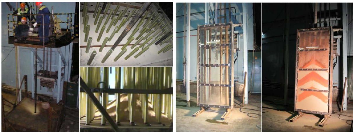
Рис. 2. Проведение макетных испытаний технологии бесполостного заполнения
