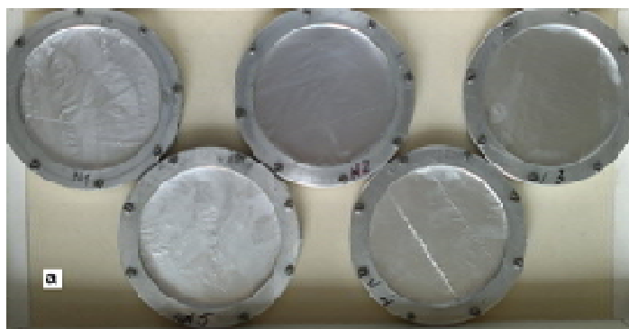
Рис. 2. Контейнеры для облучения образцов полимерной пленки ионами гелия
