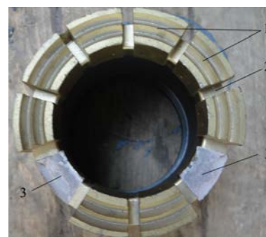
Рис. 9. Макет коронки с эксцентриситетом торца матрицы (КИТ): 1 – алмазосодержащие сектора; 2 – малый промывочный паз; 3 – место удаленных алмазосодержащих секторов с образованием больших промывочных каналов
