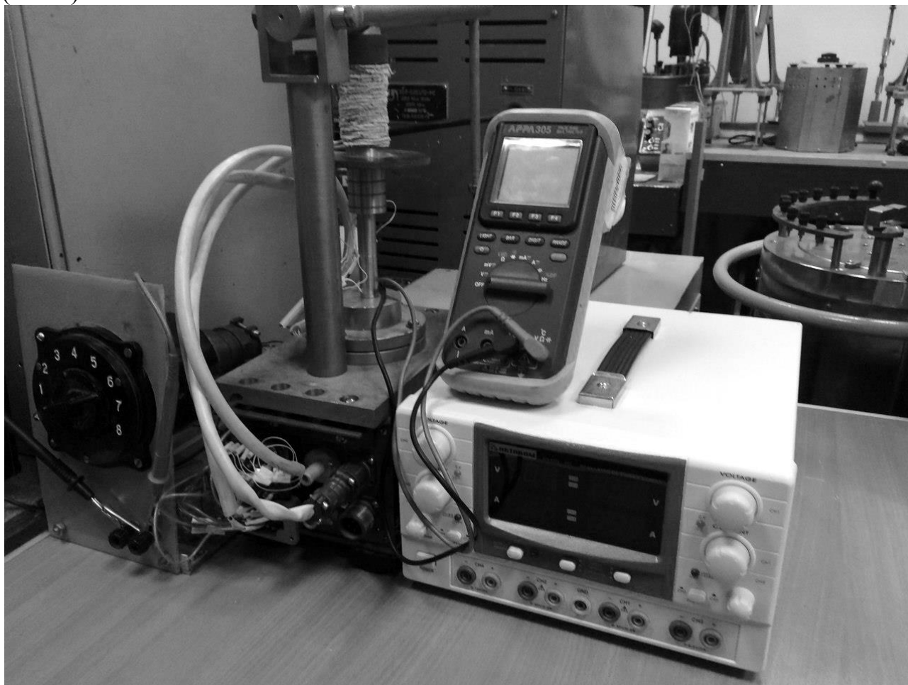
Рис. 2. Установка по определению коэффициента теплопроводности методом стержня
