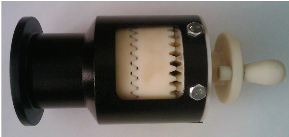
Рис. 4. Модель соосного редуктора на основе полуобкатной плоскоконической передачи
