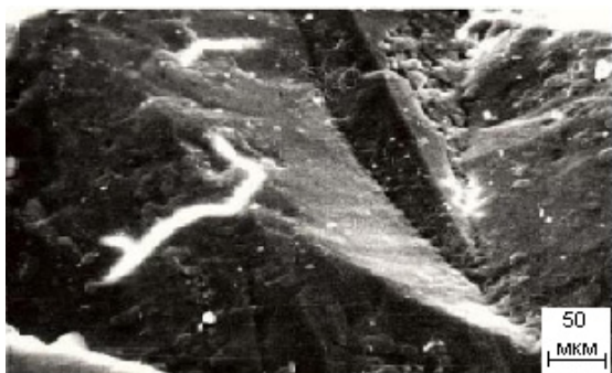
Рис. 5. Скульптура грани (011) со следами растворения и образования ямок травления
