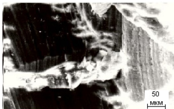
Рис. 7. Уступы разбиты трещинами
