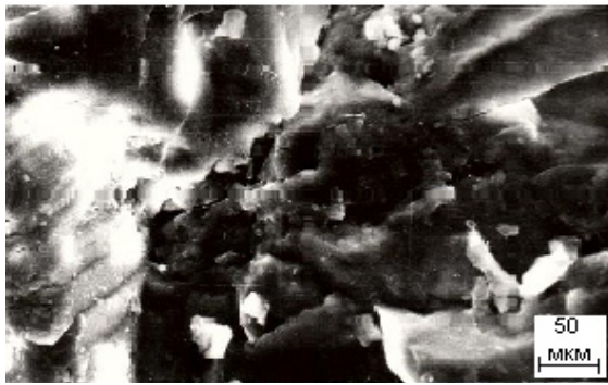
Рис. 2. Микрорельеф грани (101) кристалла узеллита со следами растворения и выступами
