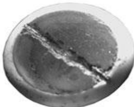
Рисунок 1.4 - Разрушение кромок призм на рабочей поверхности РС ПЭП после интенсивной работы
