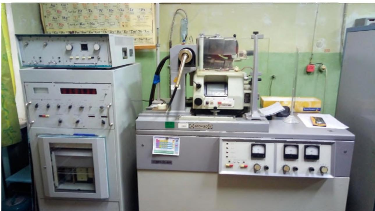
Рисунок 6 – Рентгеновский аппарат ДРОН-2
