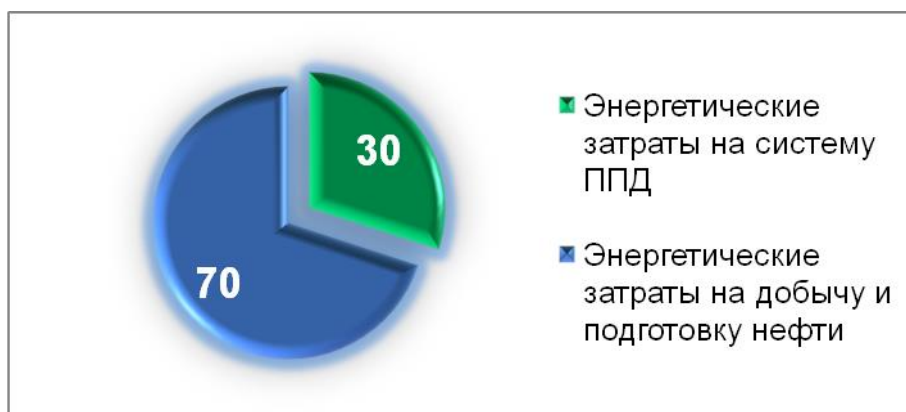
Рисунок 15 – Энергетические затраты системы поддержания пластового давления
