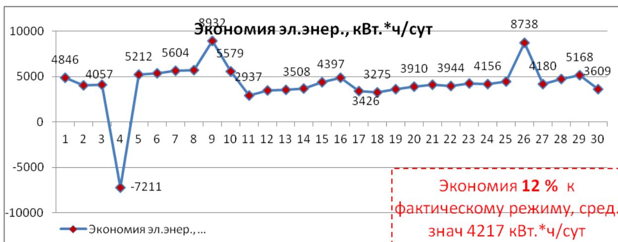
Рисунок 19 - Расчёт экономии электроэнергии при частотном приводе, кВт.*ч/сут на примере Ш... месторождения за сентябрь 2015г
