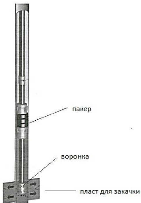
Рисунок 12 - Схема подземного оборудования нагнетательной скважины
