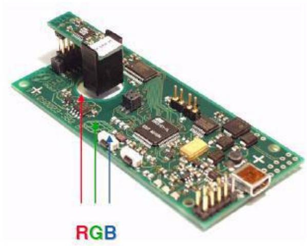
Рисунок 2 - Оценочная плата для определения цветowych координат.
