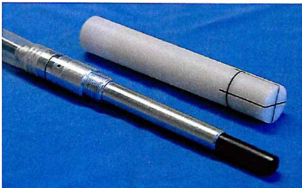
Рисунок 6 – Цилиндрическая ионизационная камера FC65-G [4]
