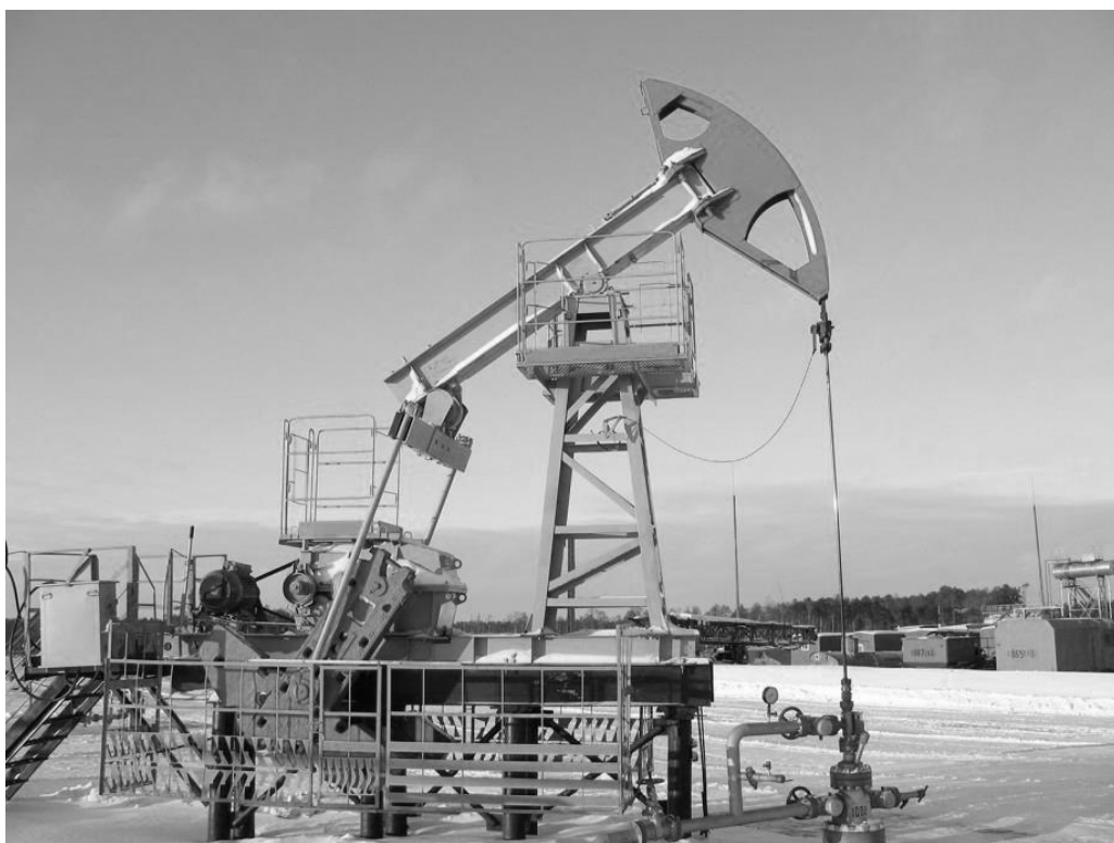
Рисунок 3 – Скважина, оборудованная ШГН
