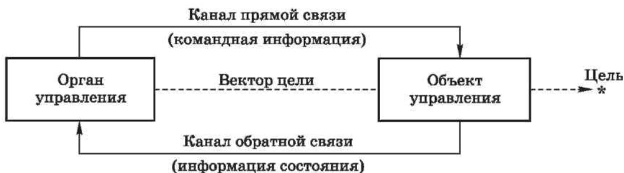
**Рис. 1. Принципиальная схема построения и действий системы управления**
