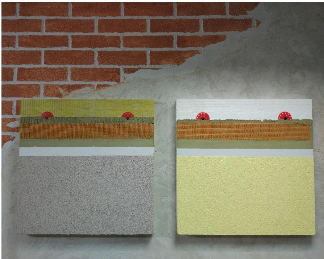
Рисунок 12 – Макеты с демонстрацией всех этапов утепления и отделки фасада.
