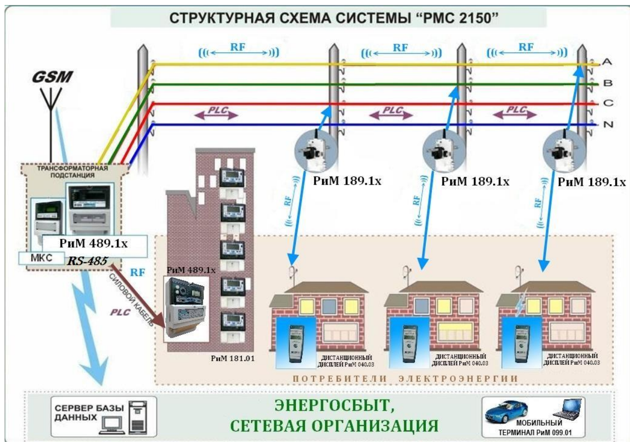
Рисунок 1.2 – Структурная схема системы «РМС 2150»
