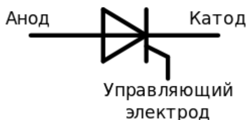
Рисунок 1.3.1.2. Схематическое изображение тиристора[7].
