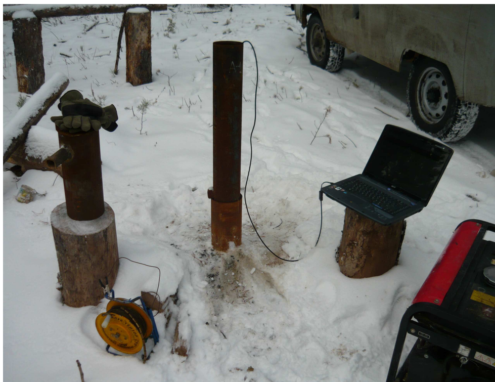
Рисунок 2.7 - Снятие показаний с даталоггера
