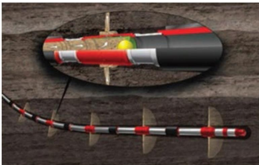
Рисунок 11 – Технология МГРП с применением раздвижных муфт, активируемых шарами
