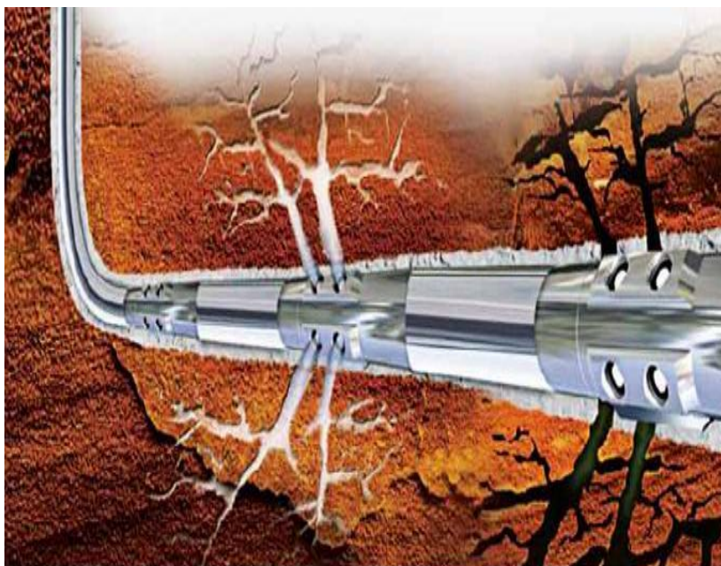
Рисунок 10 - Многостадийный ГРП с использованием разрывных муфт ВРС
