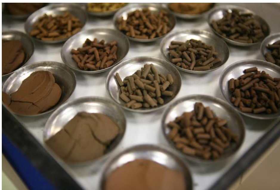
Рисунок 3.11 – Образцы грунта после выполнения индикативных тестов - определения пределов пластичности и текучести [63].
