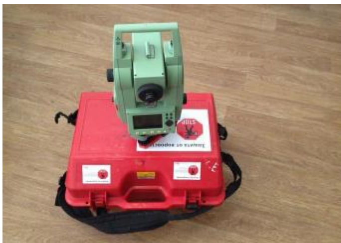
Фото 3.1. – Тахеометр «Leica TCR 405» (автор: Гредюшкин Г.И.).
