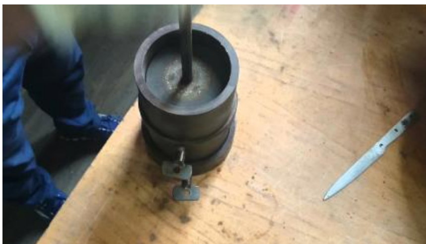
Рисунок 3.12 – Определение плотности грунта методом режущего кольца [63].
