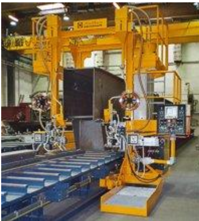
Рисунок 7 - Установка для сварки профилей и балок [9]
