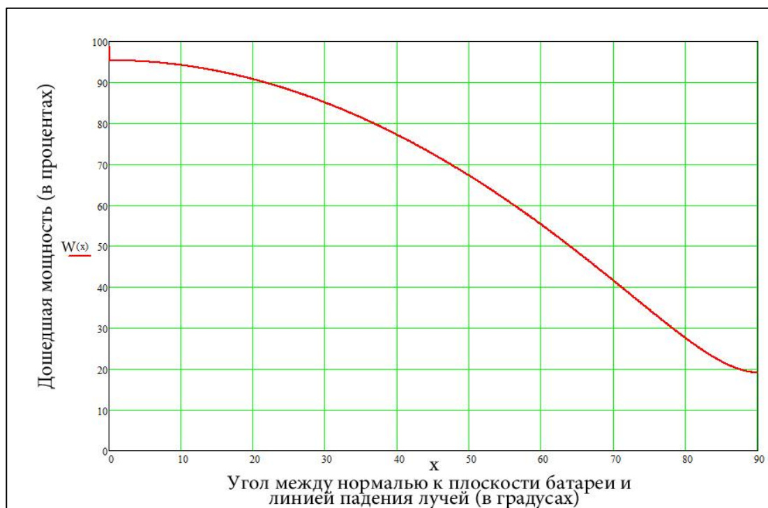
Рисунок 10 – Зависимость мощности солнечной панели от угла падения на неё лучей
