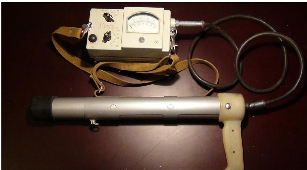
Рисунок 3.2 – Сцинтилляционный радиометр поисковый СРП-68-01
