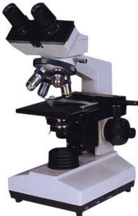
Рисунок 3 – Оптический микроскоп для изучения шлифов в проходящем свете
