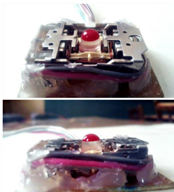
Рисунок 2.5 - Лабораторный макет системы сдвиговых деформаций
