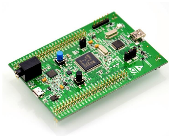
Рисунок 4 – Внешний вид отладочной платы STM32F3Discovery
