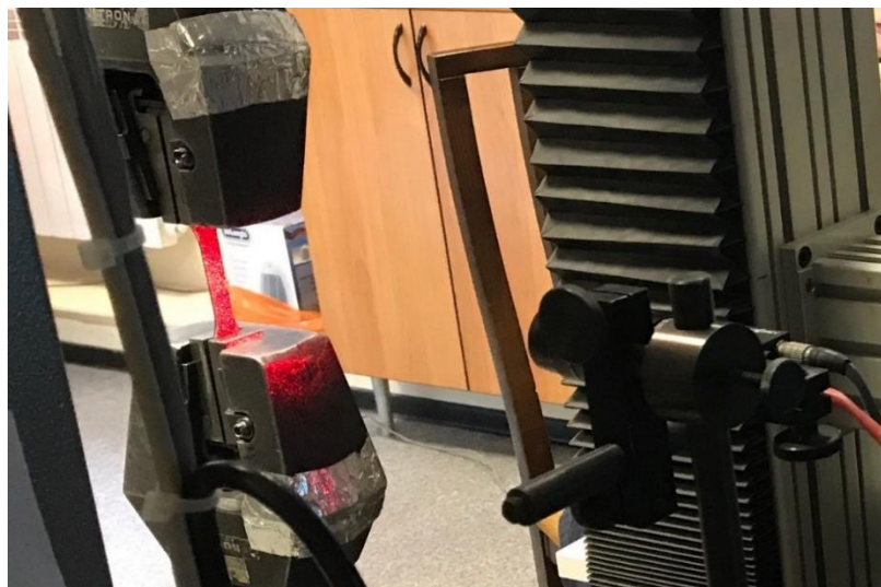
Рисунок 5.4. Съемка спеклограмм методом DIC
