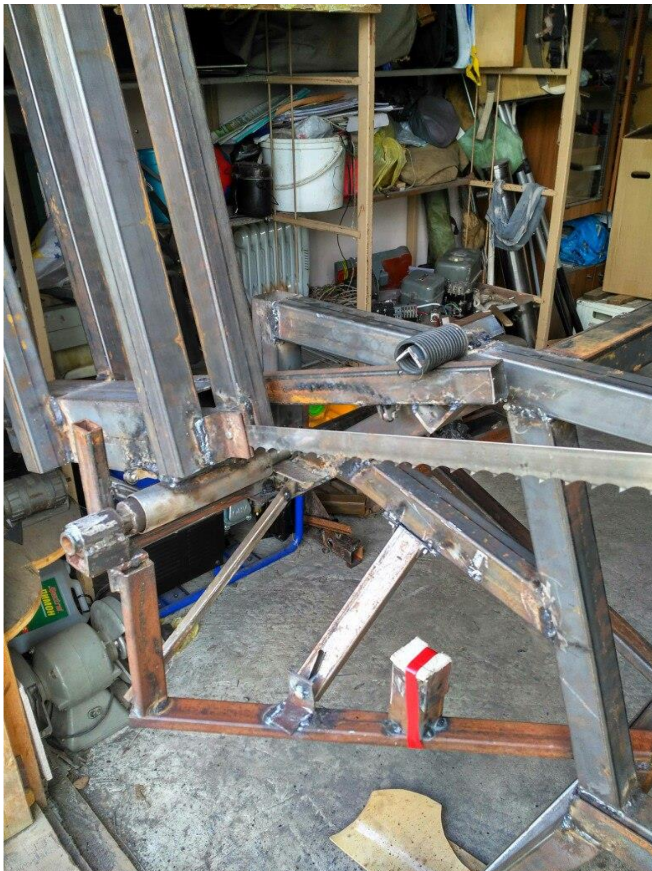
Рис. 2 Механизм крепления лучковой пилы
